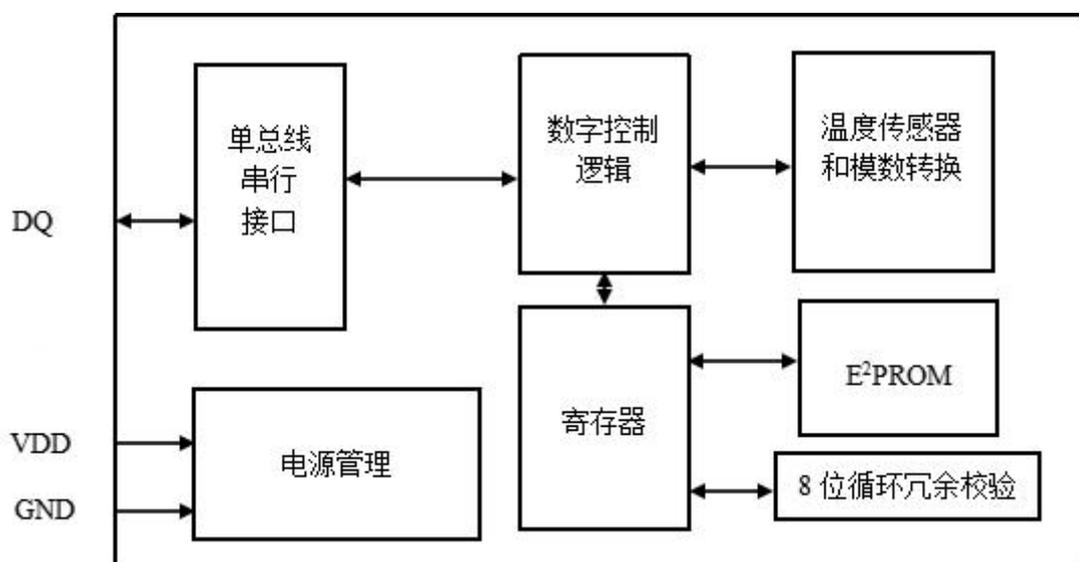
温度传感器的原理框图见上图。暂存器包含了两个字节的温度寄存器，存储来自于传感器的数字输出。另外，暂存器和扩展暂存器提供了报警触发阈值寄存器。配置寄存器允许用户设定温度转换重复性和连续测量频率。状态寄存器可以查询报警状态。数据可存入非易失性单元，芯片掉电时数据不会丢失。
