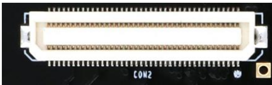
图 2-9-2 CON2 扩展口连接器的实物图
