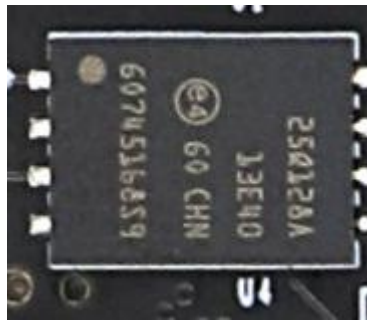
图 2-5-2 QSPI FLASH 部分实物图
