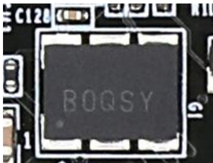
图 2-3-2 200M 有源差分晶振实物图
