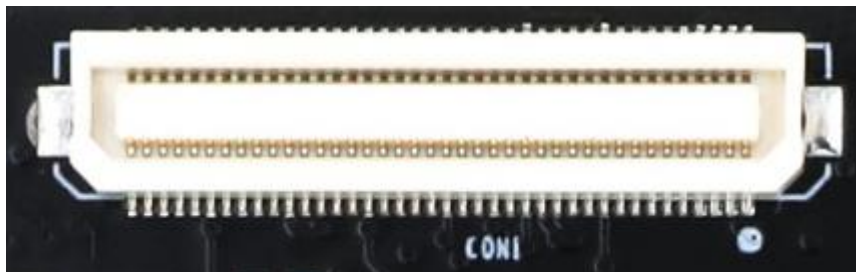
图 2-9-1 CON1 扩展口连接器的实物图
