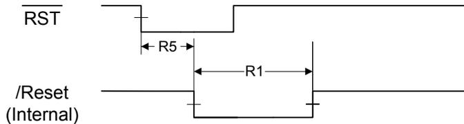
**Figure 25-9. Software Reset Timing**
