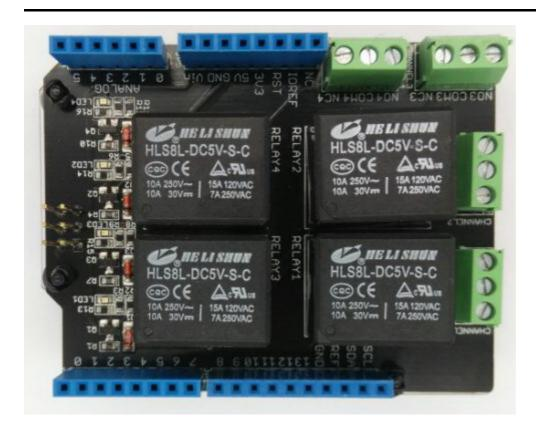
Relay Shield 是一种能通过高电压和大电流的电子器件,它解决了 Arduino 无法用自身 I/O 口控制高电压或大电流的问题。
