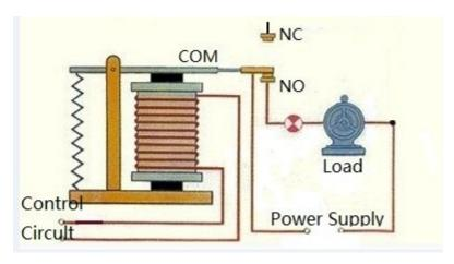
在 Relay Shield 中,四个继电器中的每一个的两个"Control Circuit"端子仅由一个 Arduino 数字 I/O 引脚控制。 引**期 4,5,6** 和 **7** 分别控制继电器 **4,3,2** 和 **1** 。
