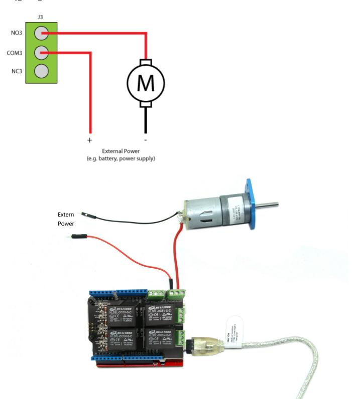
!!!Note 上图中的外部电源可以是电池或电源。 外部电源必须能够提供足够的电流并将其设置为电机的正常工作电压。在我们的示例中,我们使用锂电池作为电机的外部电源。
