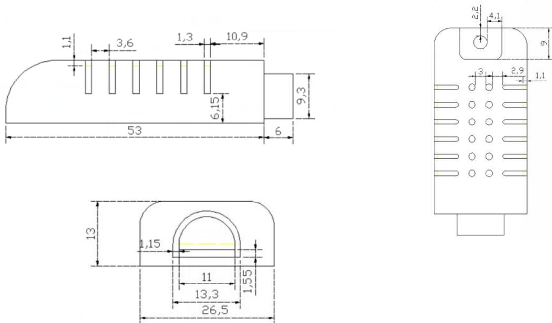
图1 (外壳) 尺寸图(单位: mm 误差±0.5mm)
