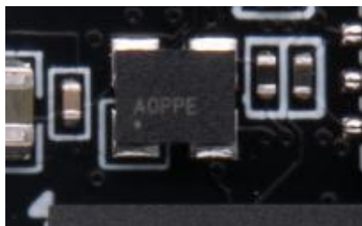
图 2-5-2 33.333333Mhz 有源晶振实物图
