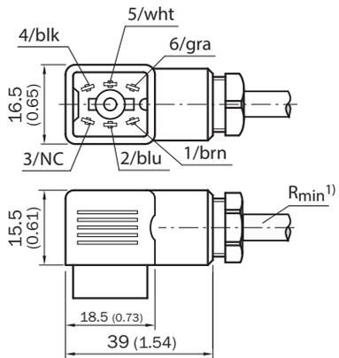
① 在动态应用时的最小弯曲半径  $R_{\min} = 20 \times$  电缆直径
