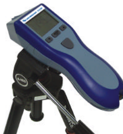
Montage des Laser-Tachometers auf einem Stativ
