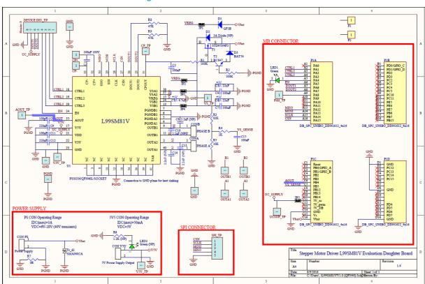
Figure 3. Eval-L99SM81VQ schematic
