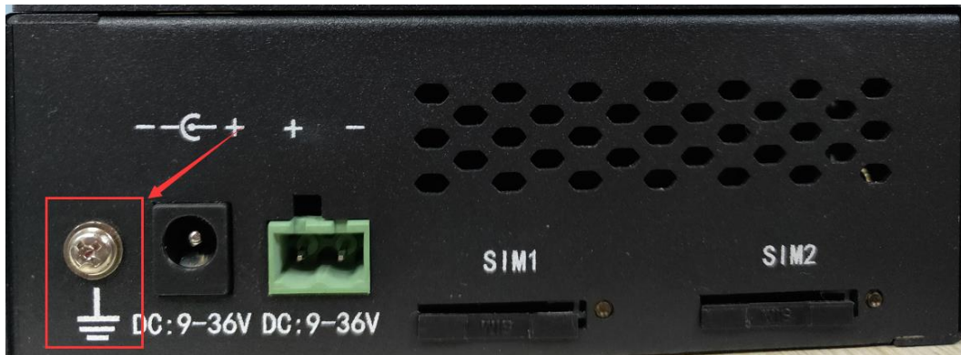
图 2 接地螺丝所在位置
