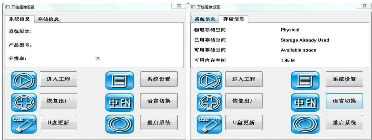
系统设置，在系统设置中可以查看当前系统信息，主要包含有当前应用软件版本号，版本类型以及本机的 IP 地址（若无以太网则显示不支持）；可以通过滚动条来调节背光亮度；在校准中可以对触摸屏的触控点阵进行校准；IP 地址可以设置以太网 HMI 的 IP。
