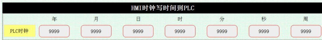
C、在 PLC 上监控对应的 VW100 到 VW112，状态表中监控，并把对应的格式调整为十六进制即可显示时间。
