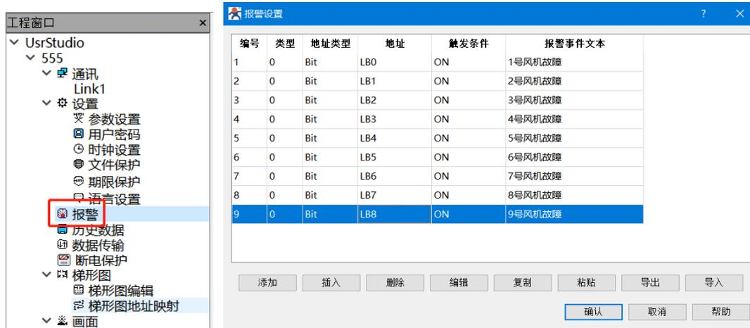
2、在报警设置中添加对应的报警事件并更改报警事件的触发条件
