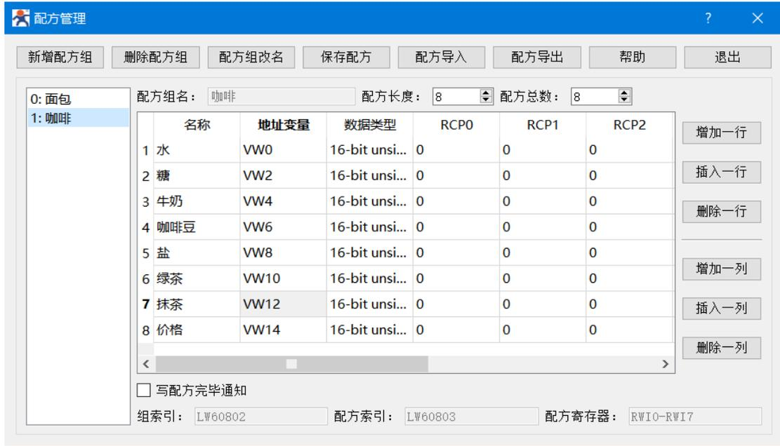
在工程画面中添加对应的组件并设置对应变量，其中配方组索引为修改内部寄存器 LW60802 可以实现配方组的切换；配方索引为修改内部寄存器 LW60803 可以实现当前配方组中配方的切换。
