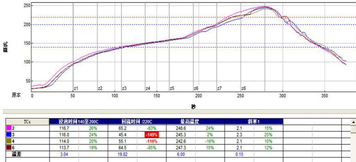
图片 8 回流焊焊接温度曲线图
