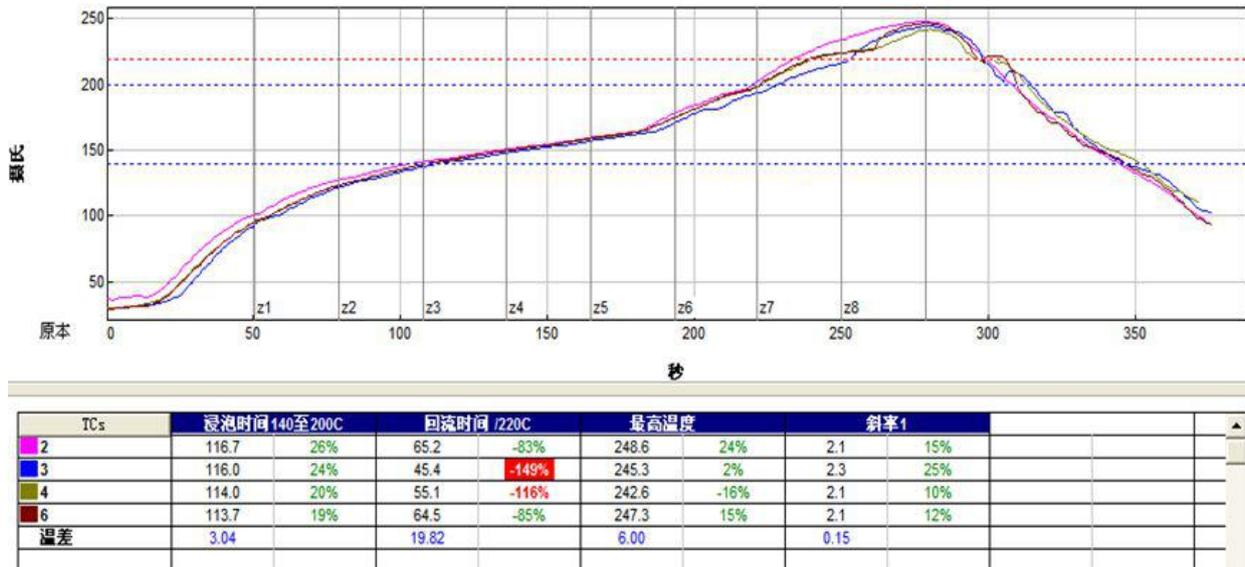
图片 11 回流焊焊接温度曲线图
