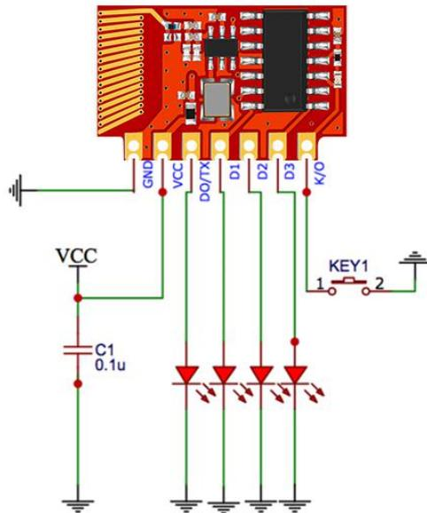
发射端用灵-T3A时，引脚对应灵-R1输出：K3-D0, K2-D1, K1-D2, K0-D3，如需更多按键，请选择串口模式，灵-T3A的4个按键可以组合，最多支持15个。
