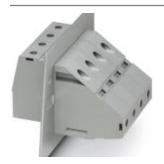
Durchführungsklemme, 接线方式: 螺钉连接, 螺钉连接, 位数: 1, 负载电流: 232 A, 横截面: 25 mm² - 95 mm², AWG 4 - 3/0, 导线连接方向与拔插方向的夹角: 90°, 宽度: 25 mm, 颜色: 灰色
