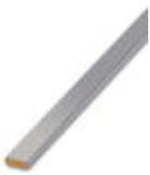
汇流条，宽度: 10 mm，高度: 3 mm，DIN VDE 0611-4: 1991-02，标识材料: 铜，镀锡，长度: 1000 mm，颜色: 银色
