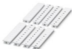
用于端子的标记条，接头，白色，标识，横向打印: L1, L2, L3, N, PE, L1, L2, L3, N, PE，安装方式: 卡接到高型标记槽，适用的模块宽度：5.08 mm，标识区域大小: 10.5 x 5.15 mm
