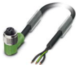
传感器/执行器电缆，3-芯，PUR 无卤素，黑色 RAL 9005，端自由出线，与孔式弯头 M12，A编码，电缆长度: 5 m
