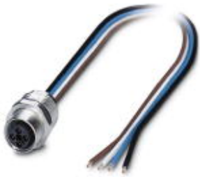
针式插座，电源，4-芯，孔式，M12，T电源，板前安装，M16 x 1.5，单线，电缆长度: 0.5 m
