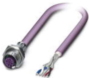
总线系统孔式插座，DeviceNet/CANopen，5芯，M12，屏蔽，A编码，Speedcon，板后/Pg9螺纹安装，带2.0m总线电缆，2 x 0.25 mm 2 ，2 x 0.34 mm 2 ，1 x 0.34 mm 2
