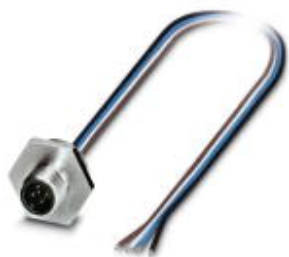
传感器/执行器插座，5芯，M12，A编码，板前/M20 x 1.5螺纹安装，带0.5mTPE绞线，5 x .34 mm 2 ，高级钢
