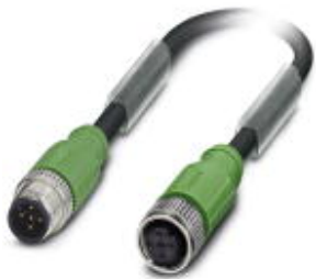
传感器/执行器电缆，5-芯，PUR 无卤素，黑-灰色 RAL 7021，屏蔽，插头 直头 M12，A编码，与 孔式 直头 M12，A编码，电缆长度: 4 m
